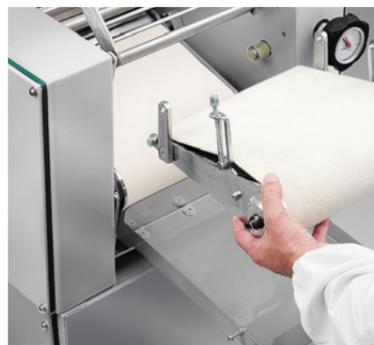
La sostituzione dei tappeti è facilmente effettuabile da parte dell'operatore.
